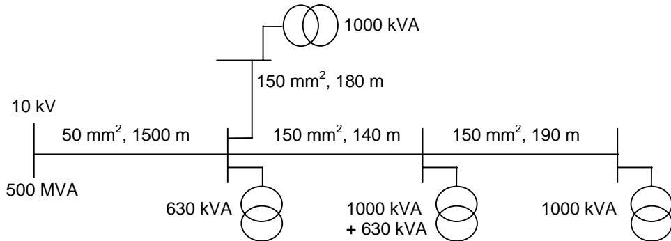
Napon kratkog spoja transformatora snage 630 kVA iznosi 5 %, a transformatora snage 1000 kVA - 6 %, pri čemu aktivna komponenta iznosi 2 % od ukupnog napona kratkog spoja. Transformatori 1000 kVA i 630 kVA nisu paralelisani na strani 0.4 kV.
