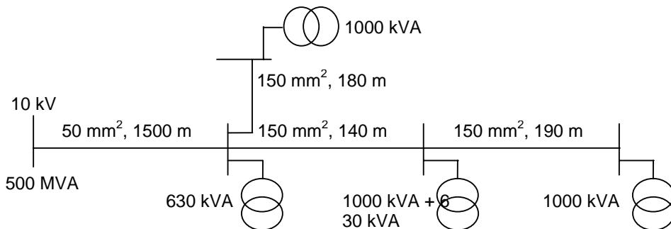
Napon kratkog spoja transformatora snage 630 kVA iznosi 5 %, a transformatora snage 1000 kVA - 6 %, pri čemu aktivna komponenta iznosi 2 % od ukupnog napona kratkog spoja. Transformatori 1000 kVA i 630 kVA nisu paralelisani na strani 0.4 kV.
