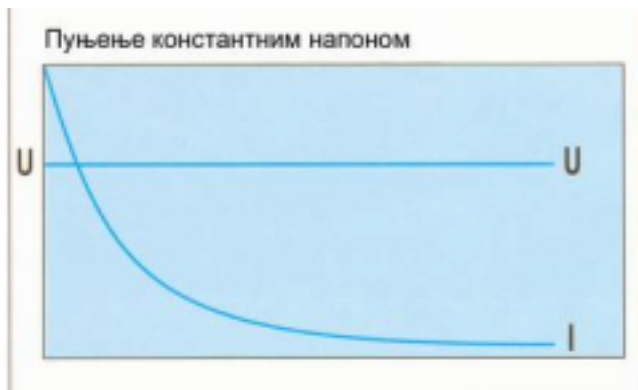
Слика 10. Графички приказ пуњења батерије константним напоном.
