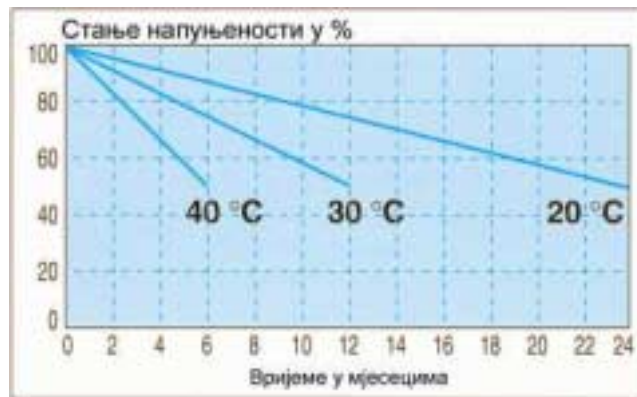
Слика 19. Зависност самопражњења батерије од температуре
