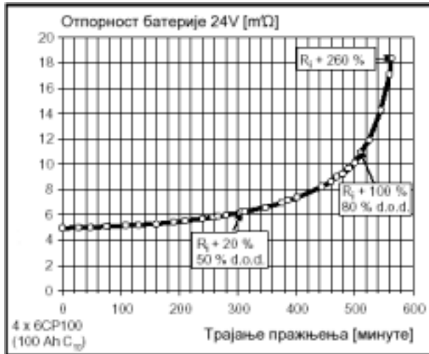
Слика 25. Зависност унутрашње отпорности од трајања пражњења
