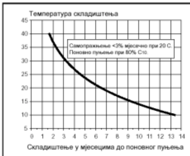
Слика 20. Графичко одређивање интервала допуњавања батерија
