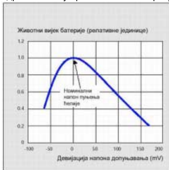
Слика 21. Радни вијек батерије у функцији напона допуњавања (енгл. float voltage )
