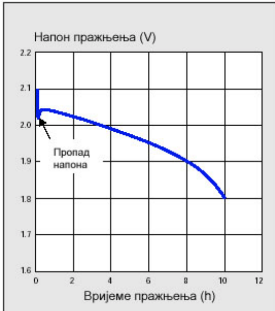
Слика 8. Зависност напона батерије у функцији времена празњења.
