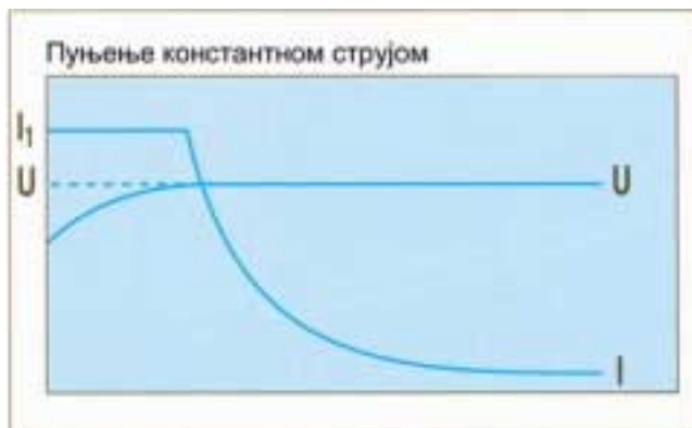
Слика 11. Графички приказ пуњења батерије по IU-карактеристици.
