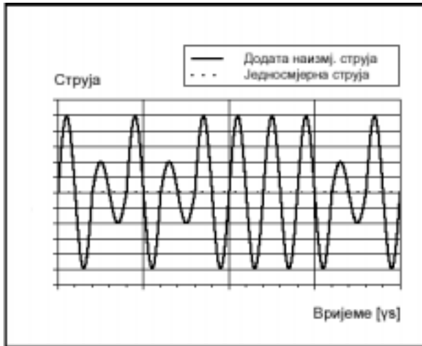
Слика 17. Графички приказ наизмјеничне валовитости струје пуњења батерије.
